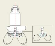
Прочный агитатор передает кинетическую энергию (энергию движения) и перемешивает твердые частицы, окружающие приемный патрубок насоса, с жидкостью с целью создания взвеси, более удобной для перекачивания.
